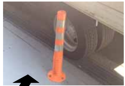
2tトラックにて試験
